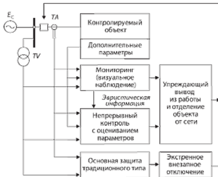
Обобщенная схема функций системы контроля параметров и защиты, обладающей упреждающими свойствами Рис. 2 •
